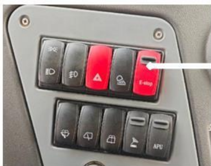
Fig.3-25 Botón de parada de emergencia (interior)
