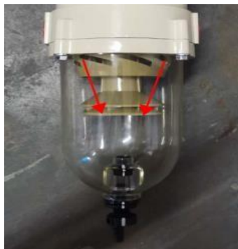
Figura 4-8 Nivel de agua no superior a la posición marcada
